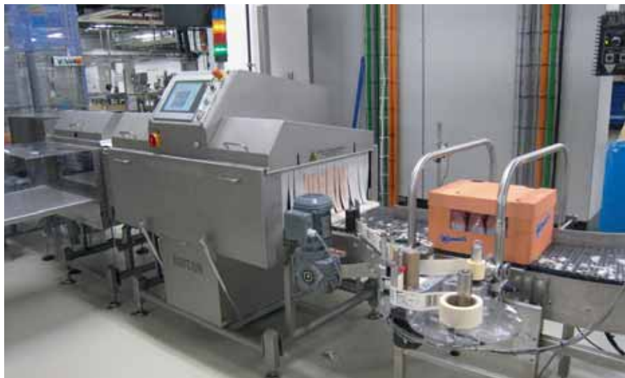
Sesotec RAYCON Inspektionssysteme, die auf Basis von Röntgen-Technologie arbeiten und eine Vielzahl von Fremdkörpern erkennen, werden von Lebensmittelherstellern weltweit zur Qualitätssicherung eingesetzt (Fotos: Sesotec GmbH)
